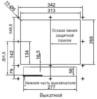
Рисунок 8 - Минимальные расстояния от токоведущих частей и металлических частей РУ до выключателя Протон М стационарного и выдвигного исполнения
