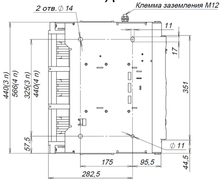
Рисунок А.4 - Выключатель Протон М 40 выдвижного исполнения (лист 1 из 8)
